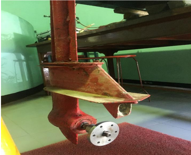
Gambar 3. 26 Tempat untuk pemasangan propeller
