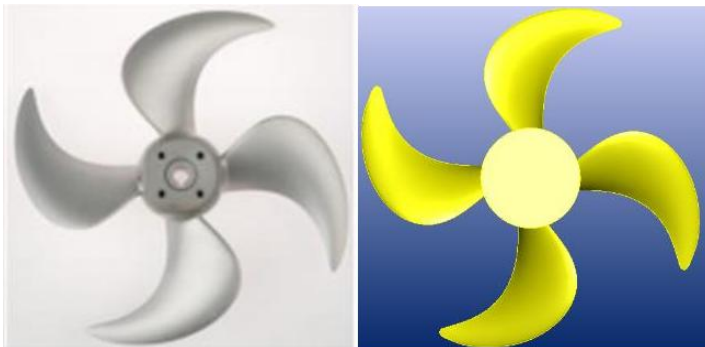
Gambar 2. 18. Model Propeller C4-40 dengan P/D 1.4 (Suranto,2018)
