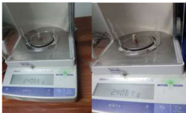
Gambar 4. 5 Pengukuran perubahan massa ( \Delta m ) pada pin bahan Polyurethane Elastomers
