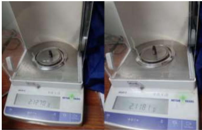
Gambar 4. 3 Pengukuran perubahan massa ( m ) pada pin bahan Nitrile Rubber.
