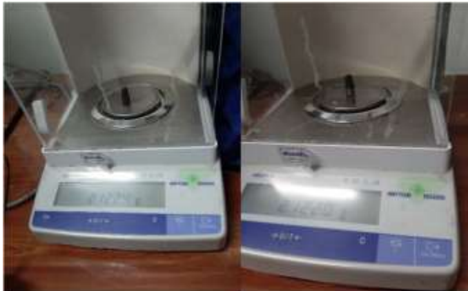
Gambar 4. 2 Pengukuran perubahan massa ( \Delta m ) pada pin bahan Nitrile Rubber.
