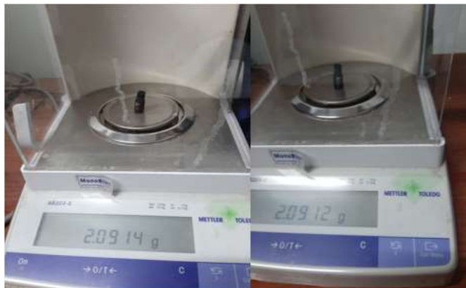
Gambar 4. 1 Pengukuran perubahan massa ( m ) pada pin bahan Nitrile Rubber.
