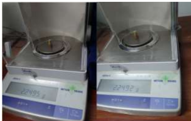
Gambar 4. 4 Pengukuran perubahan massa ( \Delta m ) pada pin bahan Polyurethane Elastomers
