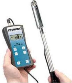
Gambar 3. 8 Anemometer
