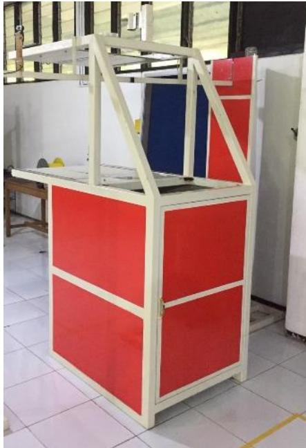
Gambar 3. 7 Penyangga Turbin Savonius
