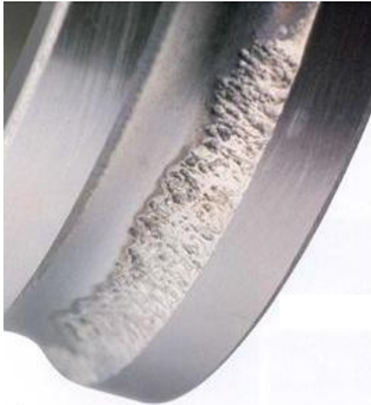
Gambar 2.11 Overload pada Bearing (McKee, 2011)
