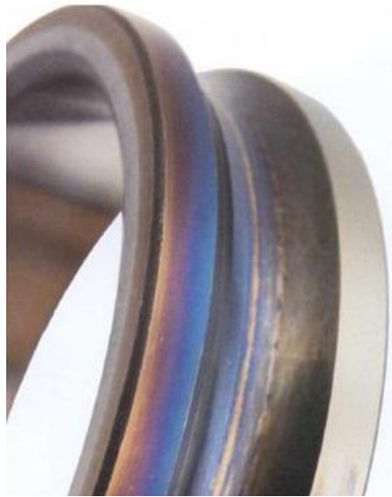
Gambar 2.9 Overheating pada Bearing (McKee, 2011)
