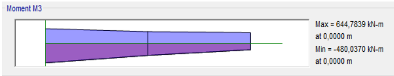
Gambar 4.39 Momen Tumpuan Arah X Pada Kolom K1 Lt.UG Momen tumpuan max = 644,784 kN-m (kombinasi envelope) Momen tumpuan min = -480,037kN-m (kombinasi envelope)
