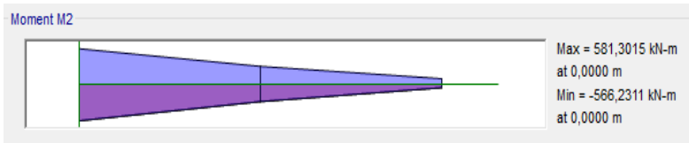
Gambar 4.40 Momen Tumpuan Arah Y Pada Kolom K1 Lt.UG Momen tumpuan max = 581,3015 kN-m (kombinasi envelope) Momen tumpuan min = -566,231 kN-m (kombinasi envelope)
