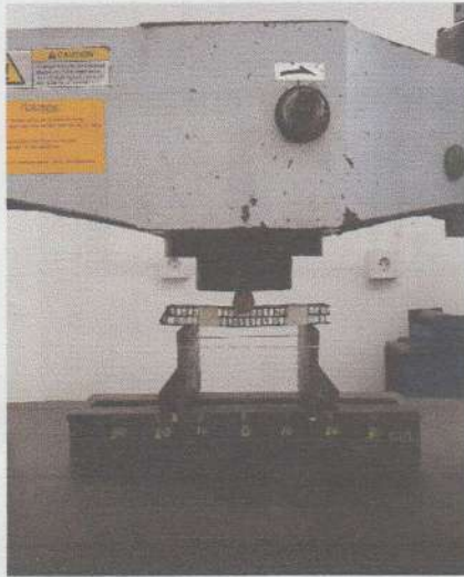
Gambar 3.15 Salah satu proses pengujian pada variasi sudut 0^{\circ}
