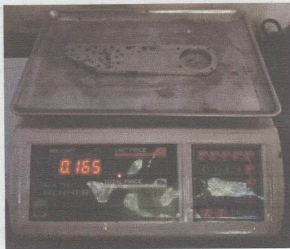
Gambar 3.20 hasil pengukuran berat komponen knuckle plate setelah di porong sesuai dengan dimensi
