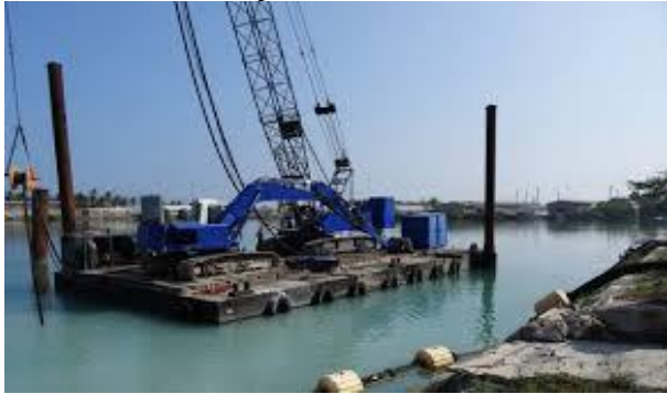
Gambar 8. 13 Ponton Pancang dan Ponton Crane (Sumber: products.damen.com)
