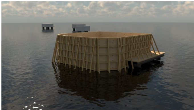
Gambar 8. 42 Ilustrasi Pemasangan Bekisting Breasting Dolphin
