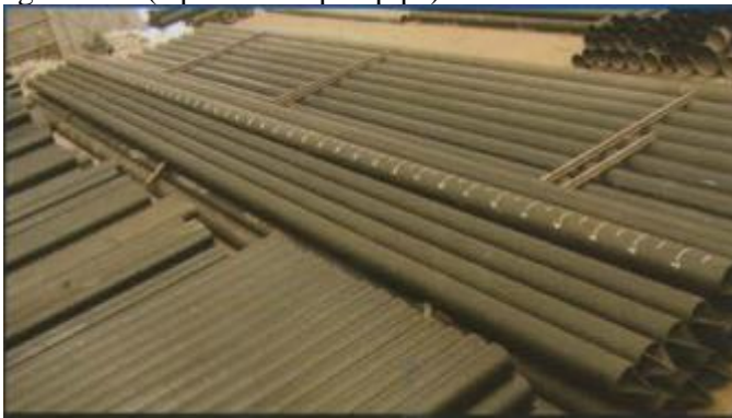
Gambar 8. 3 Tiang Pancang Baja PT. Swarna Bajapasific
