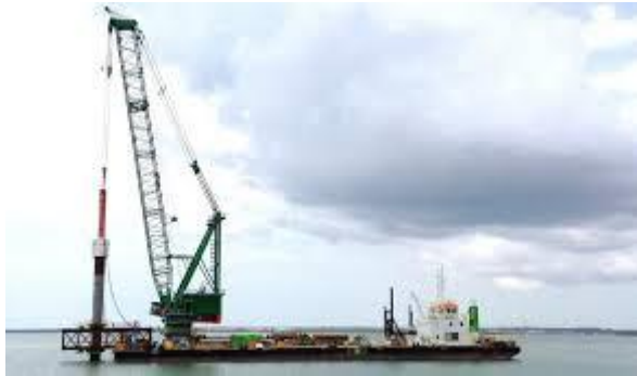
Gambar 8. 5 Contoh Barge dengan Crane dan Pile Ladder
