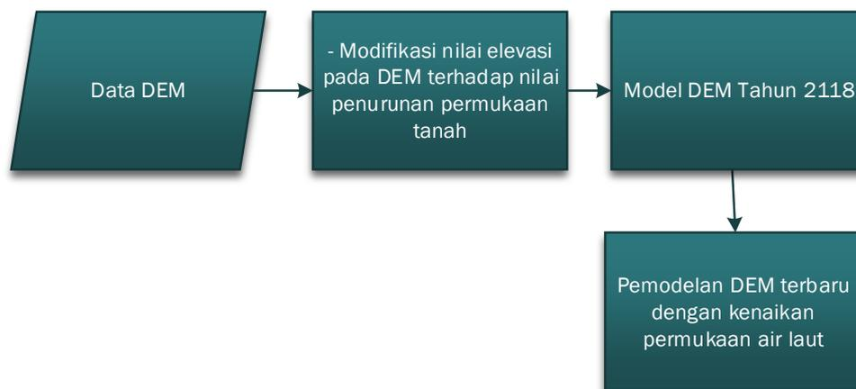
Gambar 4. 22 Diagram Pengolahan Pemodelan Area Tergenang
