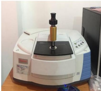
**Gambar 3.15** Alat uji FTIR
