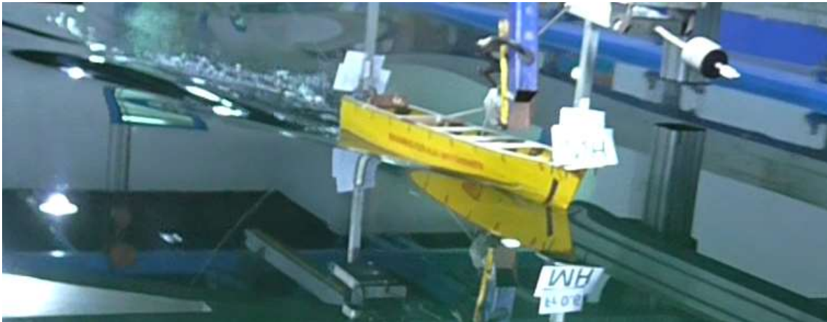
Pengujian hambatan main hull pada Fr. 0.6
