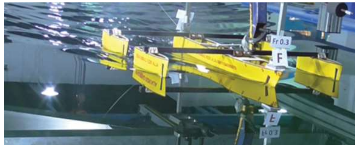
Pengujian hambatan pentamaran model F (0.4 S/L) pada Fr. 0.3
