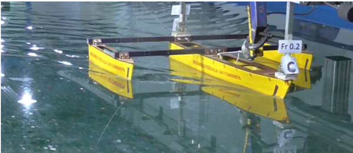
Pengujian hambatan trimaran model C (0.4 S/L) pada Fr. 0.3
