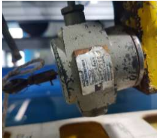
Gambar 4.13 Loadcell yang diikat pada tali
