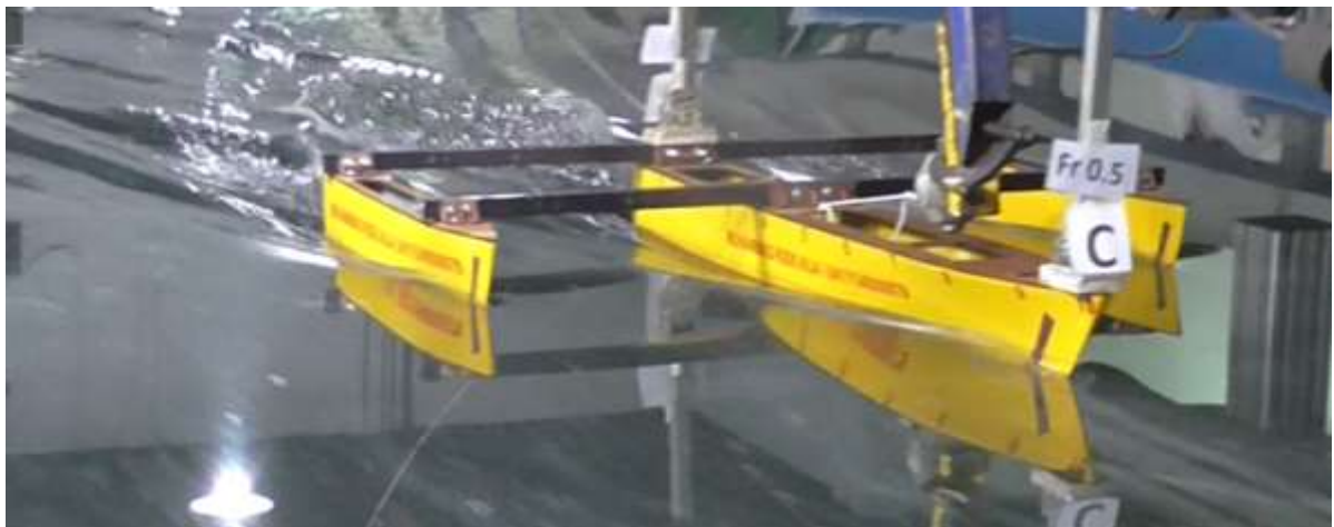
Pengujian hambatan trimaran model C (0.4 S/L) pada Fr. 0.5
