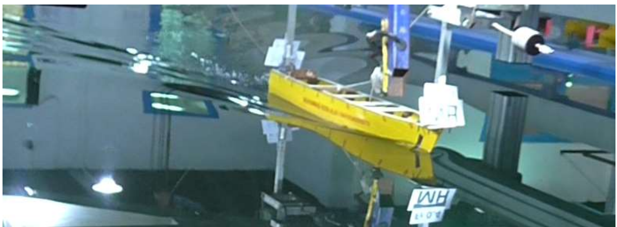
Pengujian hambatan main hull pada Fr. 0.4
