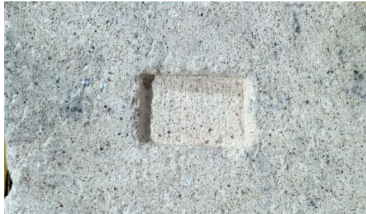
Gambar 4.7 Batu tahan api sebagai cetakan pengecoran anoda korban aluminium
