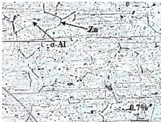
Gambar 4.12 Struktur mikro anoda korban aluminium dengan penambahan unsur paduan 0.7%Zn (Al-17.25%Zn) perbesaran 10x
