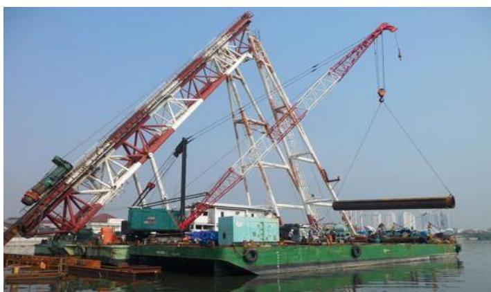
Gambar 7.18 Ponton Pancang dan Ponton Crane
