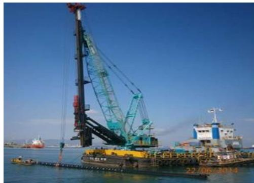
Gambar 7.8 Contoh *Barge* dengan *Crane* dan *Pile Ladder*
