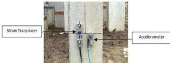
Gambar 7.24 Contoh Pemasangan Strain Transducer dan Accelerometer
