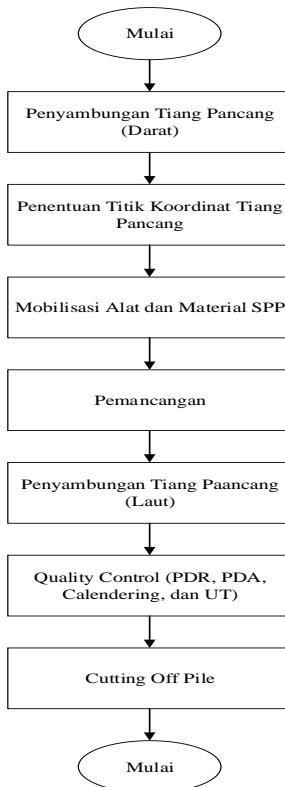
Gambar 7.4 Diagram Alir Pekerjaan Tiang Pancang
