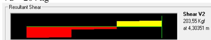
**Gambar 4. 45** Diagram geser maksimum pada titik sambungan kuda-kuda atas dengan kuda-kuda bawah
