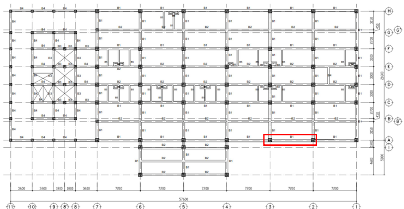
Gambar 4. 21 Rencana Denah Pembalokan (Balok Induk B1)
