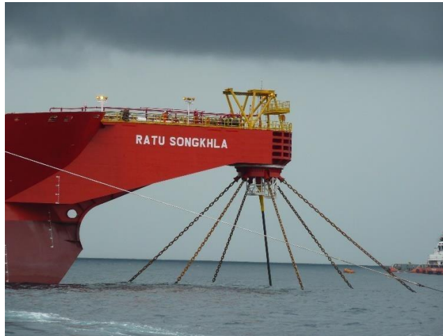
Gambar 2. 13 External Turret (Sumber: www.kisi2pelaut.com )
