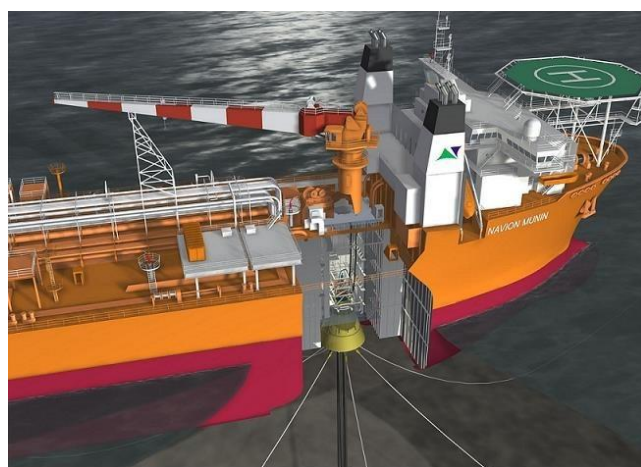
Gambar 2. 14 Internal Turret (Sumber: www.kisi2pelaut.com )
