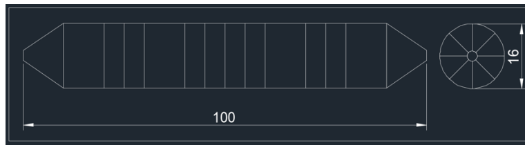
Gambar 4. 8. Desain Struktur Kandang Ikan Silindris
