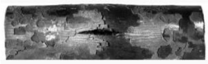
**Gambar 2. 3** *Creep pada Boiler tube (Dooley and McNaughton,1995)*
