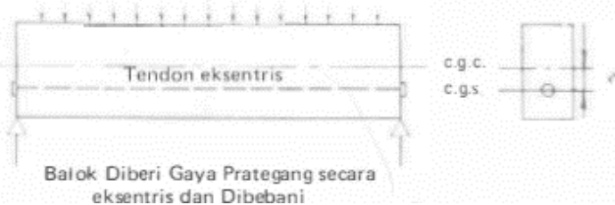
Gambar 2. 5 Contoh Tendon dengan Eksentrisitas (Sumber : T.Y. Lin, 2000)
