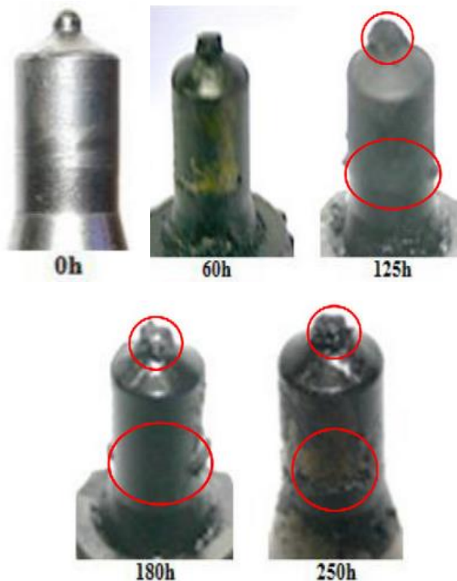
Gambar 2.3 Dampak Penggunaan B20 Jarak pada Injektor Terhadap Jam Kerja
