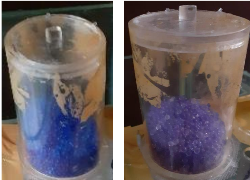
Gambar 4.3 Kondisi Gel Silika Pra-Eksperimen I pada Awal (kiri) dan Setelah 6 Hari Percobaan (kanan).
