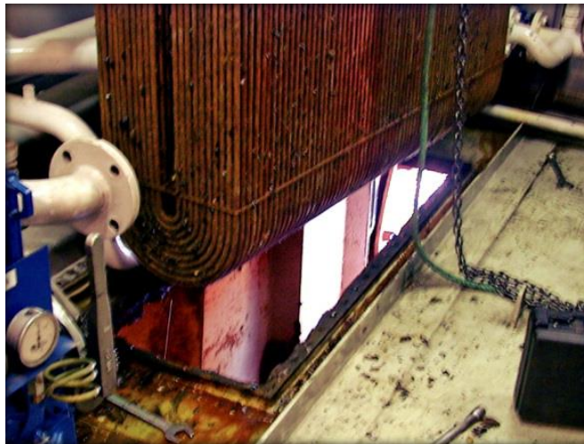
Gambar 1.1 Korosi pada sistem pendingin kapal
