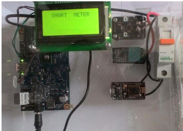
Gambar 3.3 Desain komponen Smart meter
