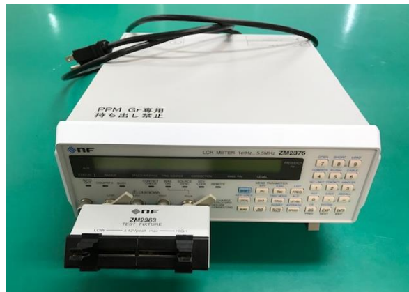
Gambar 3.11 LCR meter yang digunakan tipe nF ZM2376
