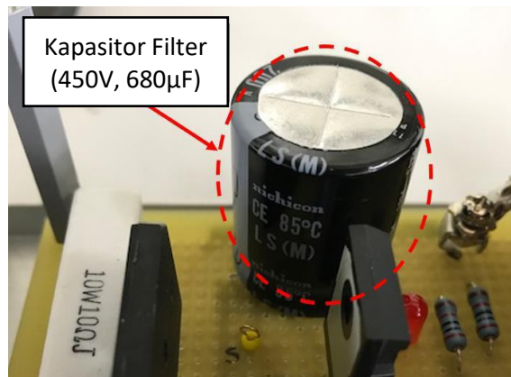
Gambar 3.12 Kapasitor filter yang digunakan (400 V, 680 \mu F )
