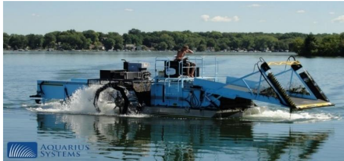
Gambar II.10 Kapal yang Menggunakan Sistem Penggerak Paddle Wheel (Sumber: https://aquariussystems.com/aquatic-weed-harvesting , 2019)
