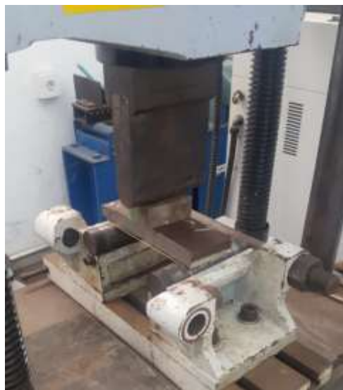
Gambar 3.13 Proses meluruskan material dengan mesin bending
