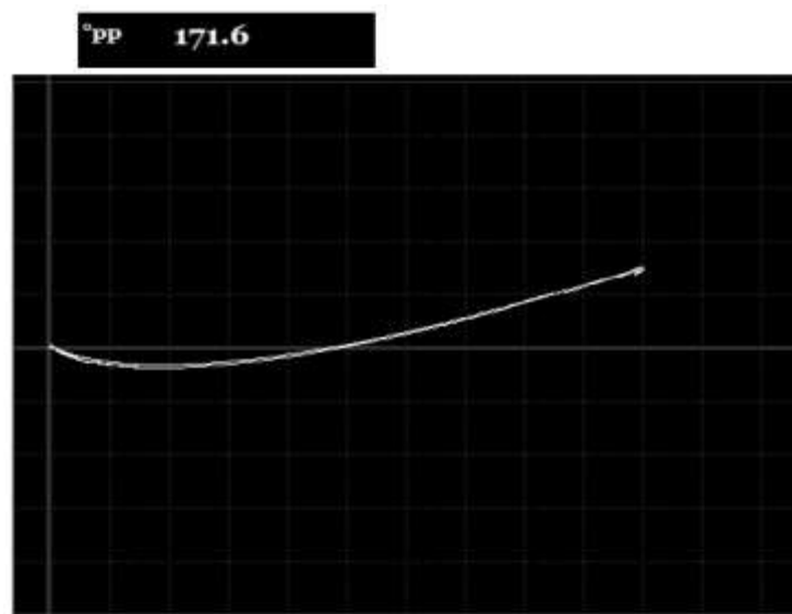
Gambar 4.2 Salah satu hasil scan blok kalibrasi pada frek.15 kHz
