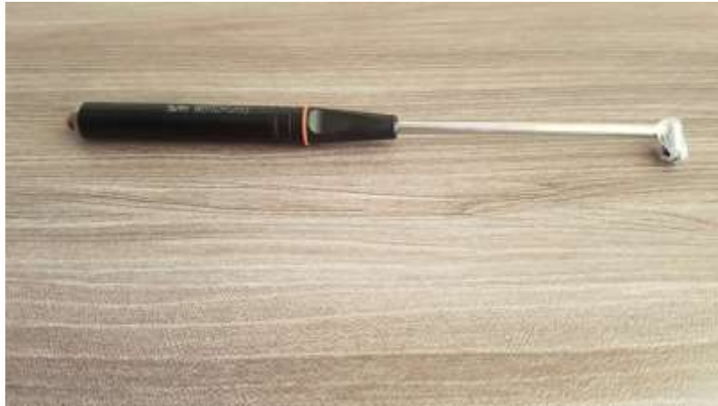
Gambar 3.6 Probe pengujian frekuensi 30 kHz
