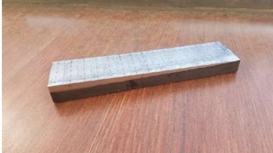
Gambar 3.14 Blok kalibrasi setelah melalui proses machining
