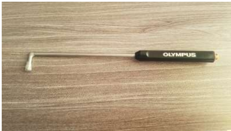
Gambar 3.7 Probe pengujian frekuensi 50 kHz
