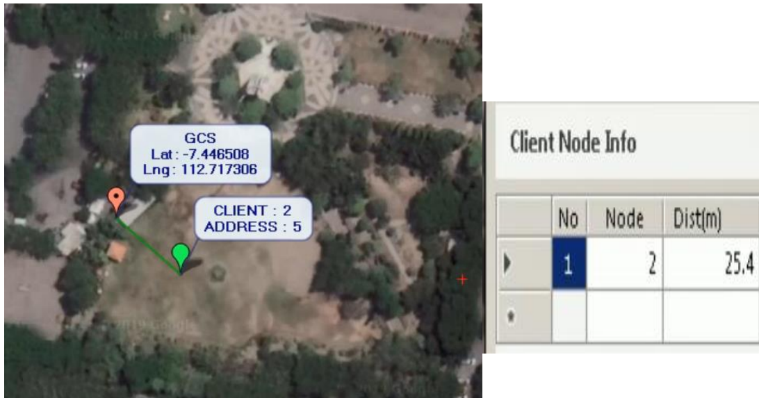
Gambar 4.18 Pengujian dengan jarak 25.4 meter menggunakan protokol MAVLink
