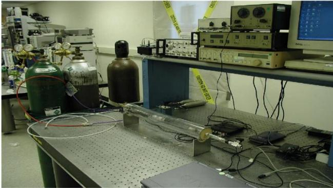
**Gambar 2. 18** Eksperimen getaran pada pipa plexiglas menggunakan fluida gas Nitrogen (Sinha, 2005)
