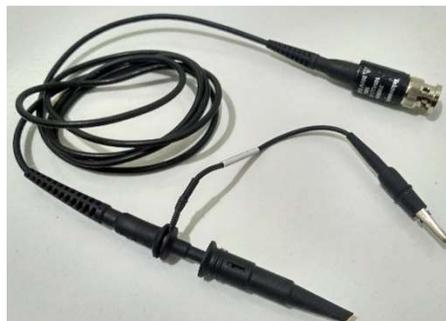
Gambar 3.22 *Probe Tegangan*
