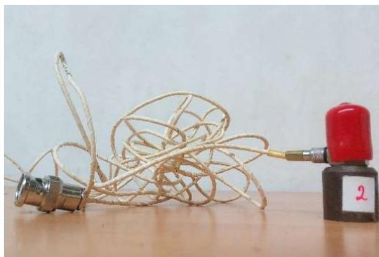
Gambar 3.19 *Accelerometer*
