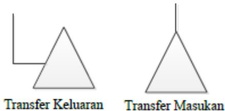
Simbol pintu “TRANSFER” menyediakan satu alat guna mencegah pengulangan bagian dari “*fault tree*”. Pintu “*transfer out*” mewakili semua cabang yang mengukutinya, digambarkan dengan simbol, katakanlah 1 dan menunjukkan bahwa cabang telah diulangi di tempat lain. Pintu, “*transfer-in*” mewakili cabang (dalam hal ini 1) yang telah digambarkan di tempat lain, dan daripada menggambar lagi adalah cukup dengan masukan pada titik tersebut. 19
