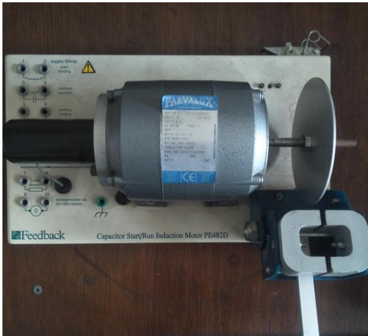
Gambar 3.2 Motor Induksi Satu Fasa Kapasitor Start/Run PE482D
