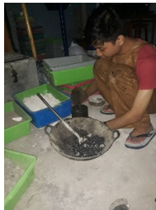
Gambar 1.f. merojok campuran dalam kondisi panas (Tahap 6)
