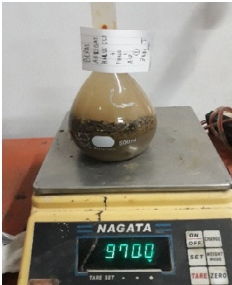
Gambar 9.a. Berat Piknometer + Air + Agregat Halus (Pengujian Berat Jenis Agregat Halus)
