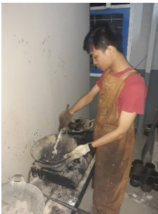
Gambar 1.e. Mencampurkan agregat dengan aspal dalam kondisi panas (Tahap 5)
