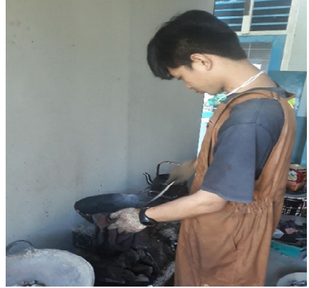
Gambar 11.b. Pencampuran Agregat dan Aspal yang Telah Dipanaskan
