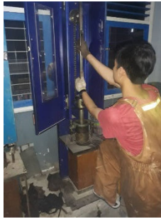
Gambar 1.g. Memadatkan campuran dengan alat compactor (Tahap 7)
