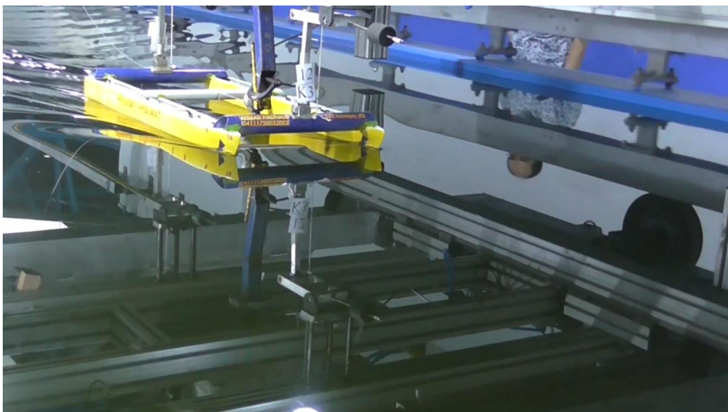
Gambar D.3 2 Kamera Depan (menangkap gambar gelombang haluan)
