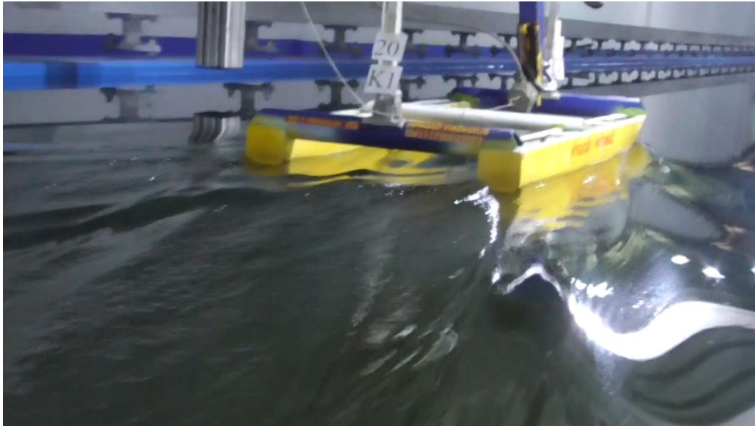
Gambar D.1 5 Kamera Buritan (menangkap gambar gelombang di buritan)
