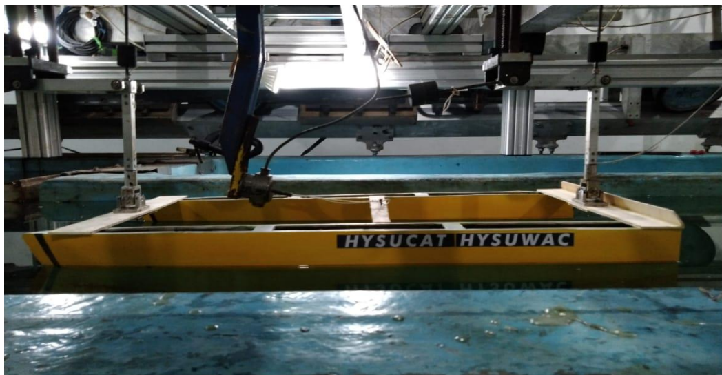
Gambar 5.2 Model uji kapal pada keadaan sarat penuh dan even keel
