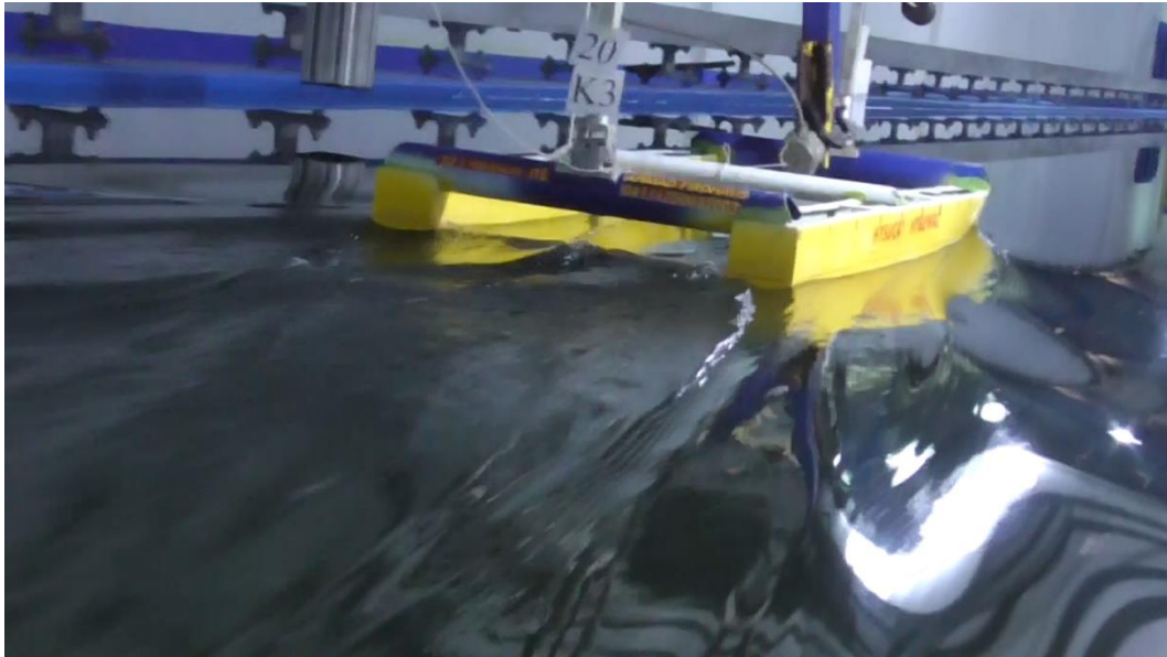
Gambar D.3 5 Kamera Buritan (menangkap gambar gelombang di buritan)
