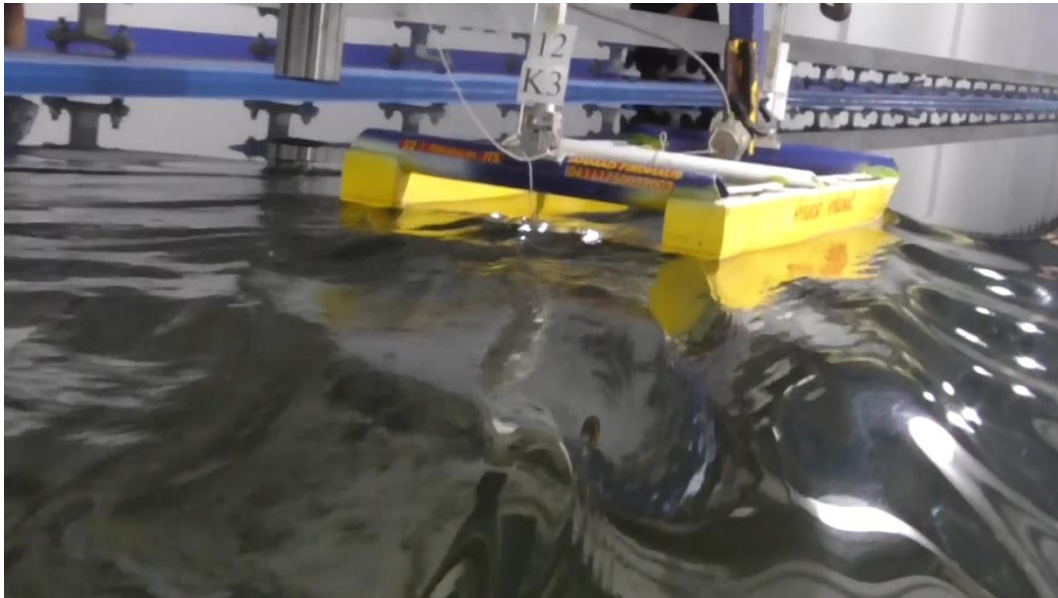
Gambar D.3 1 Kamera Buritan (menangkap gambar gelombang di buritan)
