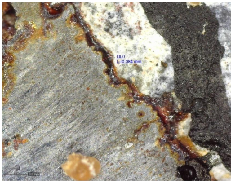
Gambar 4.8. Pengukuran Ketebalan Karat
