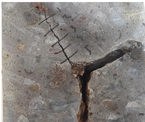
Gambar 6. Pola Retak Pada Beton dengan 5% Silica Fume di Hari ke- (a) 40, (b) 43, (c) 46, (d) 48, (e) 51
