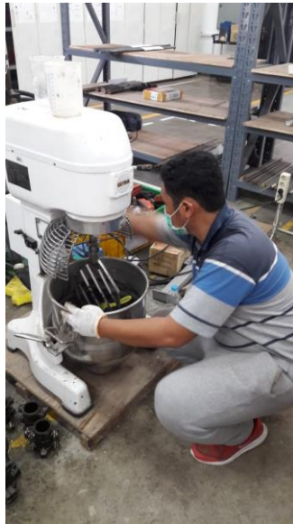
Gambar 12. Pengecoran ECC Menggunakan Mixer Khusus
