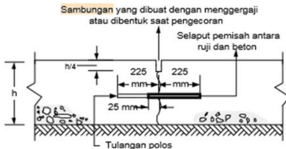
gambar 2. 13 Sambungan Susut Melintang Dengan Ruji
