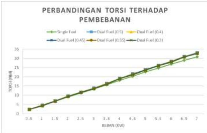
**Gambar 4.2** Grafik perbandingan torsi mesin dengan pembebanan
