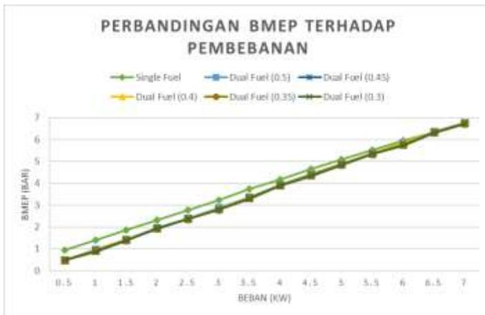
**Gambar 4.3** Grafik perbandingan *bmep* dengan pembebanan
