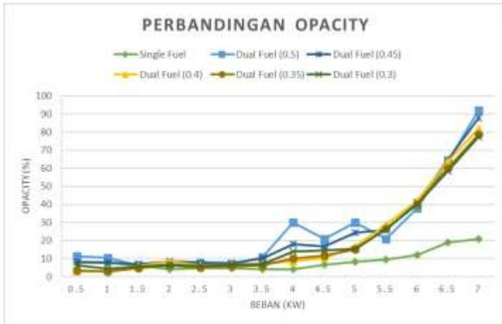
**Gambar 4.7** Grafik perbandingan *opacity* gas buang terhadap pembebanan
