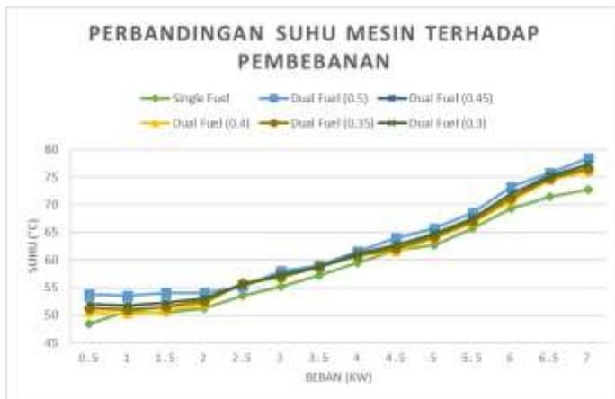
**Gambar 4.15** Grafik perbandingan suhu mesin terhadap pembebanan
