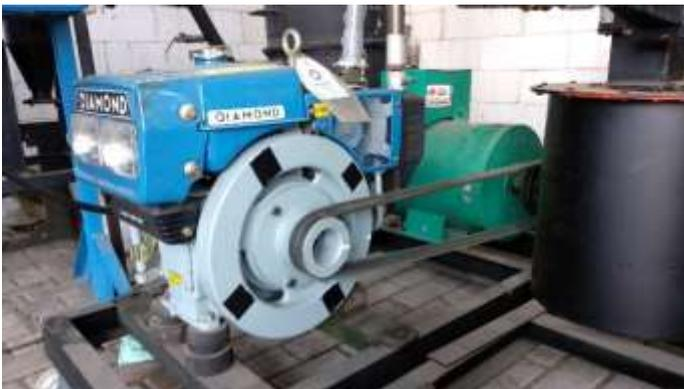
**Gambar 3.1** Satu set mesin diesel merk Diamond dengan generator DongFeng
