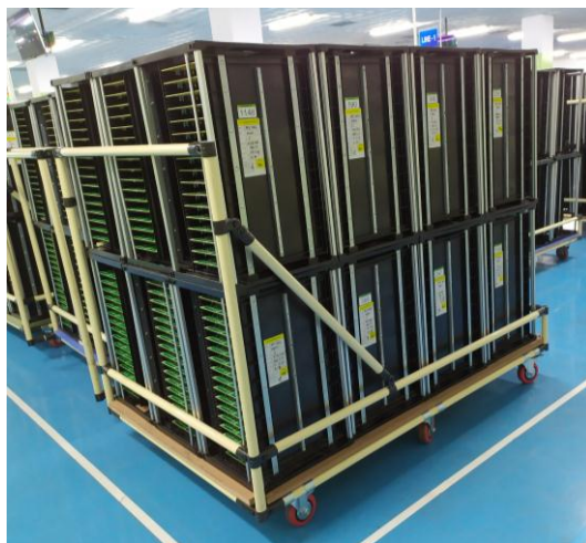
Gambar 4.21 Hand truck untuk transportasi material dari SMT ke MI
