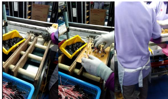
Gambar 4.14 Operator Perlu Memutar Tubuh untuk Mengambil dan Meletakkan PCB
