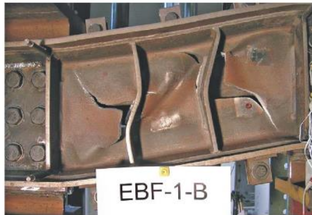
Gambar 3. 6 Sobeknya bidang geser pada link akibat pembebanan siklik (Mansour dkk, 2011)
