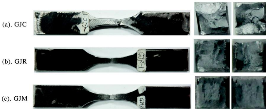
Gambar 2. 15 Coupon test untuk mengetahui perilaku siklik dari material Q345GJ (Liu dkk, 2017)
