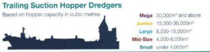
Gambar 2 15 Ukuran TSHD berdasarkan Kapasitas Hopper
