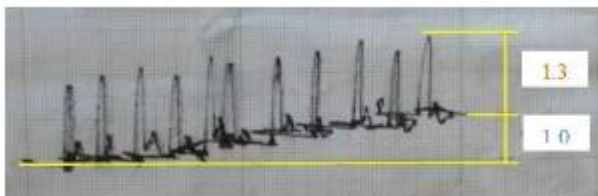
Gambar 7 22 Hasil pencatatan calendering
