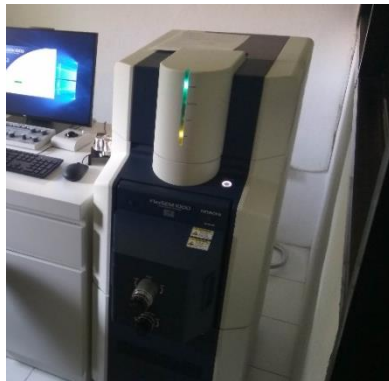
Gambar 3.7 Scanning Electron Microscope Hitachi FlexSEM 1000 dilengkapi dengan EDS dari sistem EDAX.
