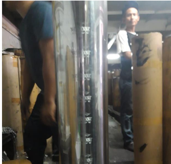
Gambar 4. 6 Silinder Cetakan Kemasan Fleksibel
