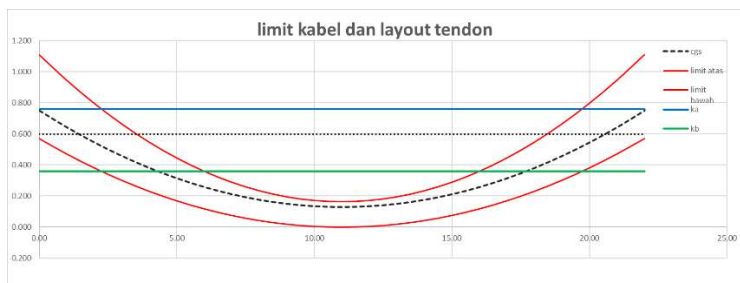
Gambar 4. 26 Limit Kabel dan Layout Tendon
