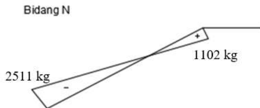
Gambar 4. 10 Gaya Dalam Bidang N pada Tangga
