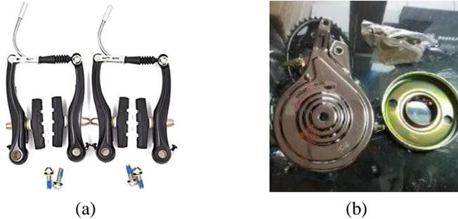
**Gambar 4.18** Pengembangan Sistem Pengereman SERAITS: (a) Rem depan; (b) Rem Belakang
