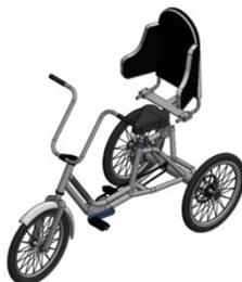
**Gambar 2. 7** Pengembangan Sepeda Pasca Stroke [Ray. 2018]. sepeda ini dirancang agar berat dan dimensi sepeda lebih kecil dari pada sebelumnya. Tetap menggunakan bahan Alumunium 6061 sehingga berat sepeda menjadi ringan, dimana semula 24 kg menjadi 22 kg. Dengan cara mengurangi dimensi yang dirasa tidak diperlukan dan membuat sepeda lebih ringan.
