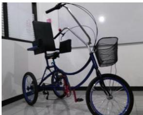
**Gambar 2. 12** Pengembangan Sepeda Pasca Stroke [Agus. 2017]. selain memperbaiki sisi kursi pengemudi, pengembangan sepeda juga dilakukan dari bentuk *frame* yang lebih ergonomis dan modern, sehingga penampilan dari sepeda pasca stroke ini lebih menarik minat orang lain untuk mencobanya.
