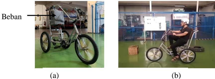
**Gambar 5. 11** Pengujian SERAITS dengan Gaya Statik dalam Posisi: a) Diam, b) Bergerak
