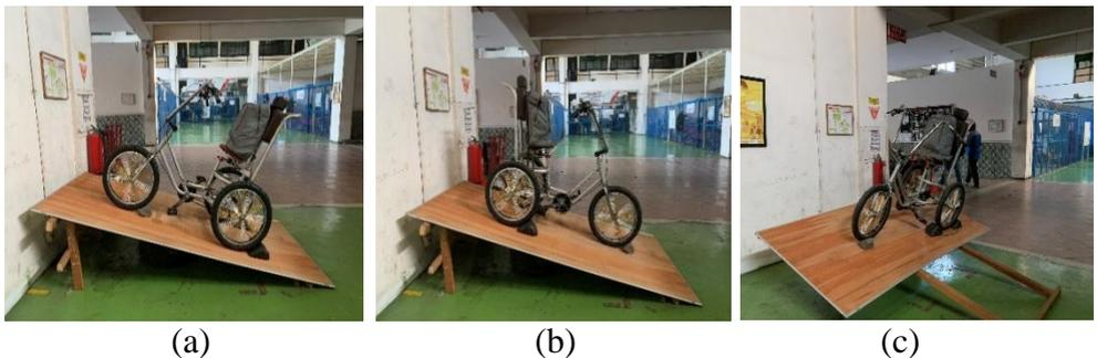
**Gambar 5. 12** Pengujian Kestabilan SERAITS : a) menghadap ke atas, b) menghadap ke bawah, c) menghadap ke samping
