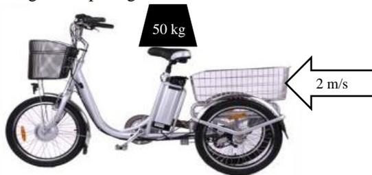
**Gambar 2.14** Uji Kekuatan Sepeda Ketika Bergerak [SNI 7519,2009]
