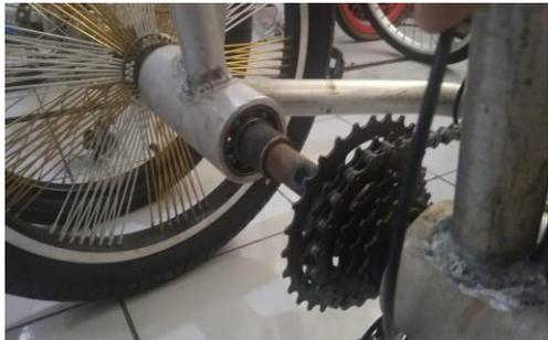
**Gambar 5. 8** Susunan Mekanisme Penggerak Roda belakang
