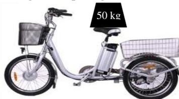
**Gambar 2.13** Uji Kekuatan Sepeda Ketika Tidak Bergerak [SNI 7519,2009]
