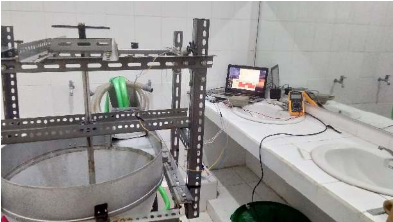
Gambar 3.4 pembangkit listrik tenaga pusran gravitasi air yang telah dibuat
