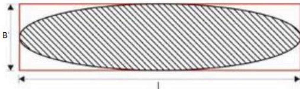
Gambar 2.5 Koefisien Waterplan (Sumber : Wibowo & Muvariz, 2017)
