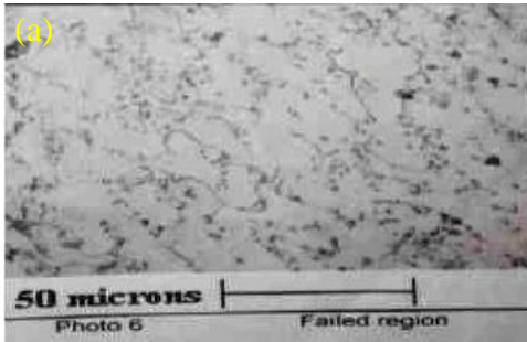
Gambar 2. 2 Gambar pengamatan mikro pada penelitian Patel Sunny Sanjay (a) Kegagalan pada daerah yang mengalami pembengkakan (b) Lapisan oxide terdapat lubang dan patah akibat creep. (Liu & Liu, 2017)
