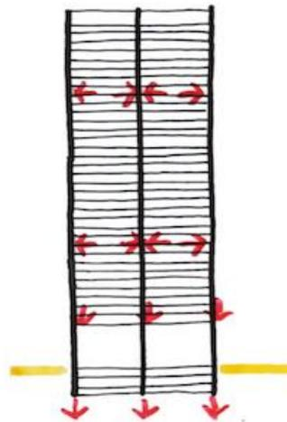
Gambar 4.13 Sistem struktur rangka kaku
