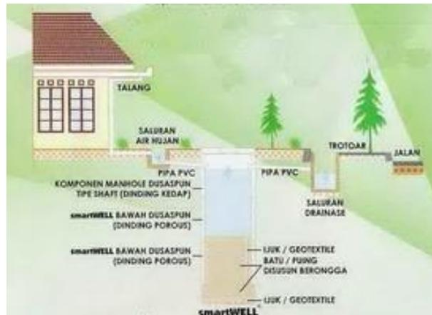
Gambar 4.10 Tampak sumur resapan
