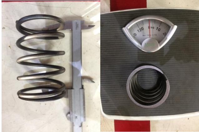
Gambar 3. 11 Skema Pengukuran Konstanta Pegas
