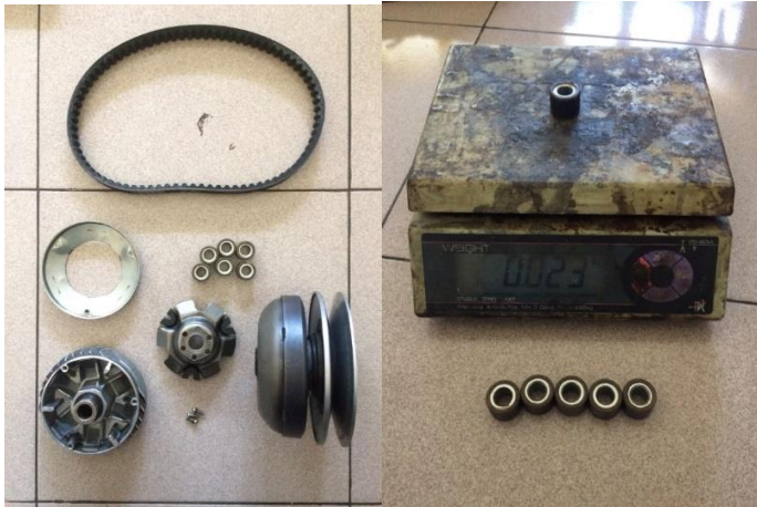
Gambar 3. 17 Pengukuran Massa Roller CVT
