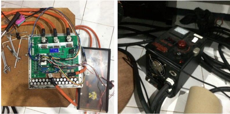
Gambar 3. 7 Perangkat Uji dan Controller dynotest
