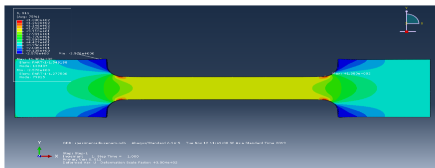
Gambar 4.16 Tegangan Pengujian Tarik arah Sumbu X beban 30% yield
