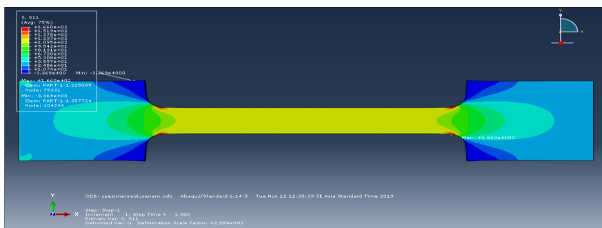
Gambar 4.26 Tegangan Pengujian Tarik arah Sumbu X beban 60% yield
