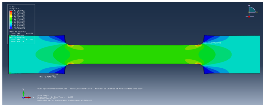
Gambar 4.1 Tegangan Pengujian Tarik arah Sumbu X beban 30% yield
