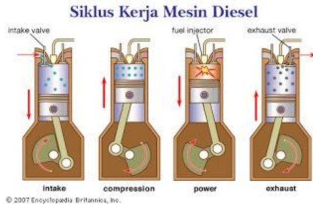
Gambar 2 3 Siklus Kerja Mesin Diesel (sumber : ardioktara-WordPress.com)
