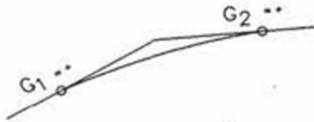
**Gambar 3. 7** Lengkung Vertikal Cembung
