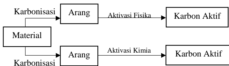
Gambar 2.4 Skema Pembuatan Karbon Aktif (Marsh dkk, 2006).
